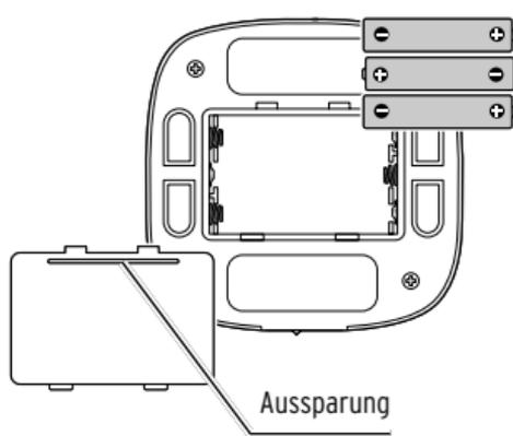
2. Haken Sie an der Aussparung unter den Batteriefachdeckel und heben Sie ihn nach oben ab.
