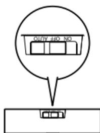
**ON** Schieben Sie den Schalter auf **ON**, um die Leuchte dauerhaft einzuschalten.
