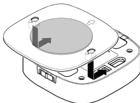
5. Setzen Sie die Wandhalterung wieder wie abgebildet auf die Rückseite auf und schieben Sie sie zur Seite. Sie muss spürbar einrasten.
